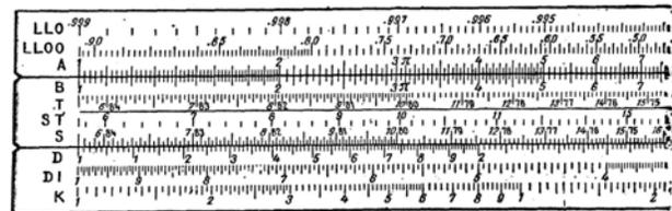
Рис. 16. Обратная сторона корпуса и движка линейки «Кейфель и Эссер»
